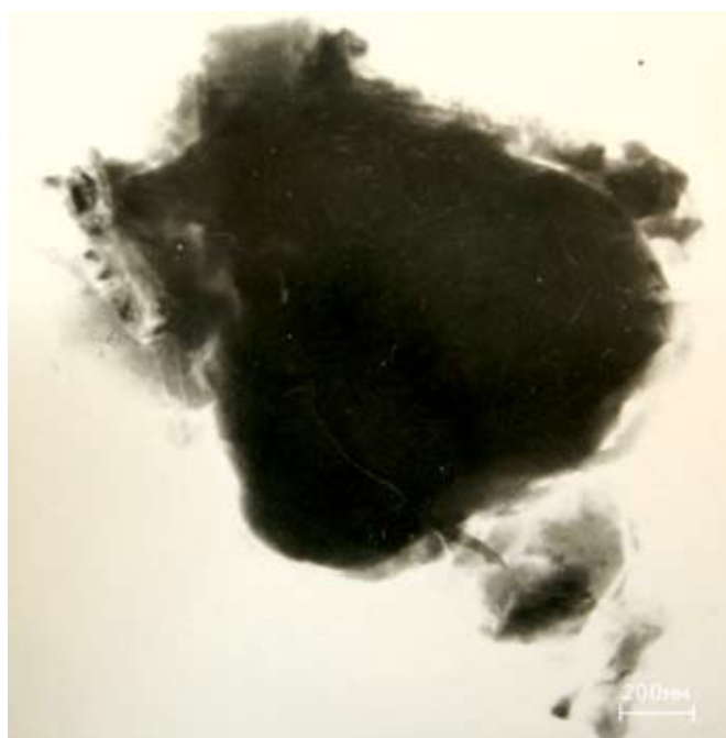
Рис. 7. Электронно-микроскопические снимки оболочкового голубого фталоцианинового пигмента. Видны расположенные на поверхности дисперсных частиц силикатного зерна — \gamma \text{Ca}_2\text{SiO}_4 нанощелочки из диоксида титана рутильной формы. Масштаб — на фото
