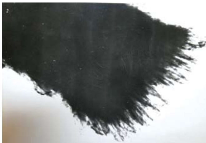
Рис. 6. Электронно-микроскопические снимки оболочкового жаростойкого пигмента № 180. На поверхности частиц самораспыляющегося носителя — \gamma \text{Ca}_2\text{SiO}_4 наблюдается оболочка из волокон игольчатого цветного пигмента. Увеличение в 15000 раз
